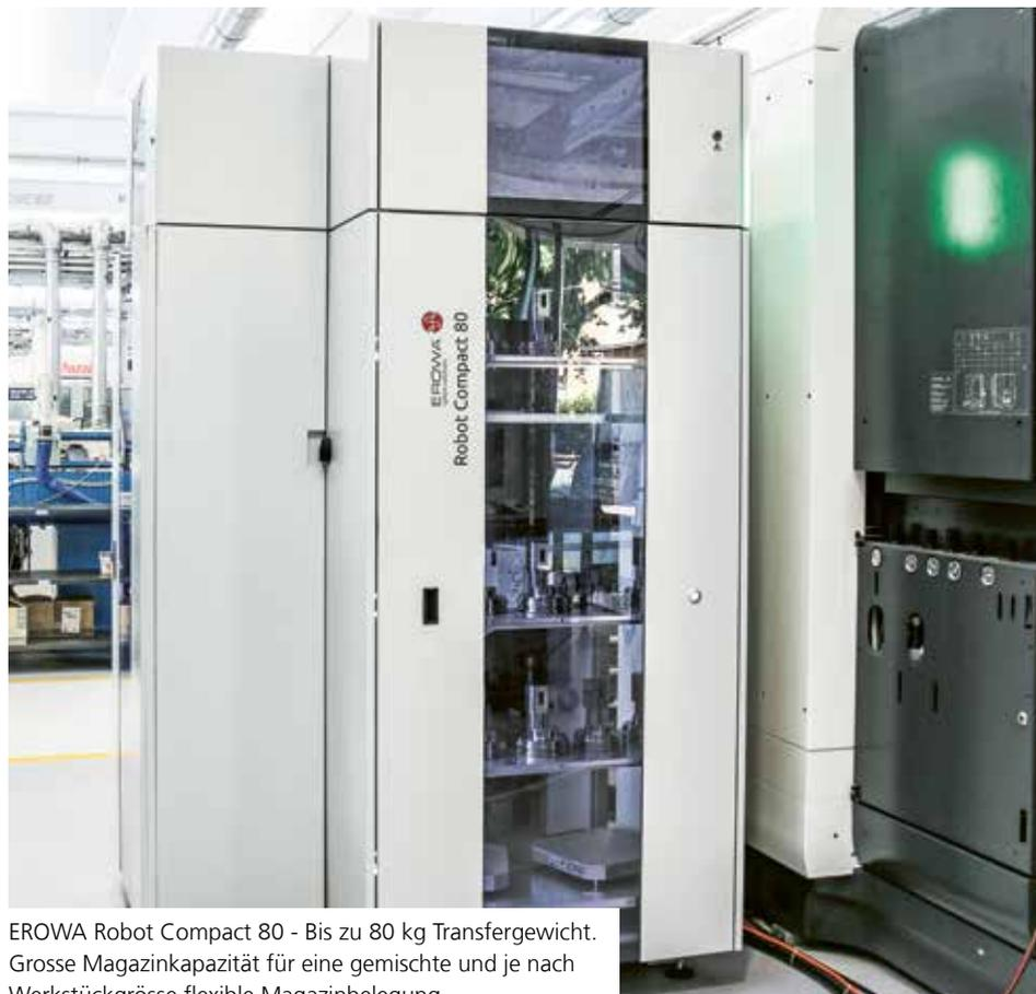
EROWA Robot Compact 80 - Bis zu 80 kg Transfergewicht. Grosse Magazinkapazität für eine gemischte und je nach Werkstückgrösse flexible Magazinbelegung.
